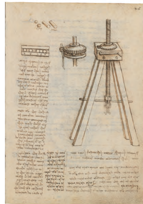
Rodamientos a bolas. Codex Madrid I (Mss. 8937, f. 26r).
