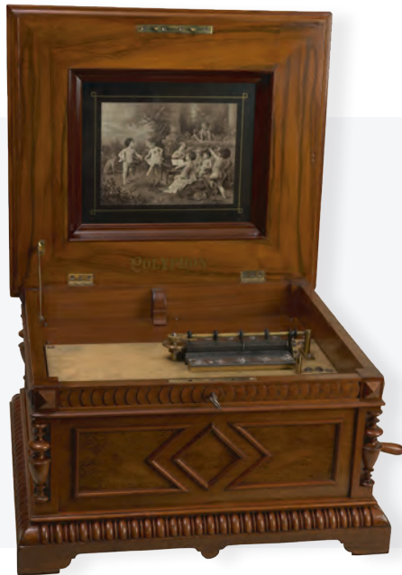
Caja de música de 156 púas y 28 notas. Reprodutor de música mecánica de la marca Polyphon Musikwerke, marca creada en Leipzig y patentada en 1889. BNEM, CEE2825.
